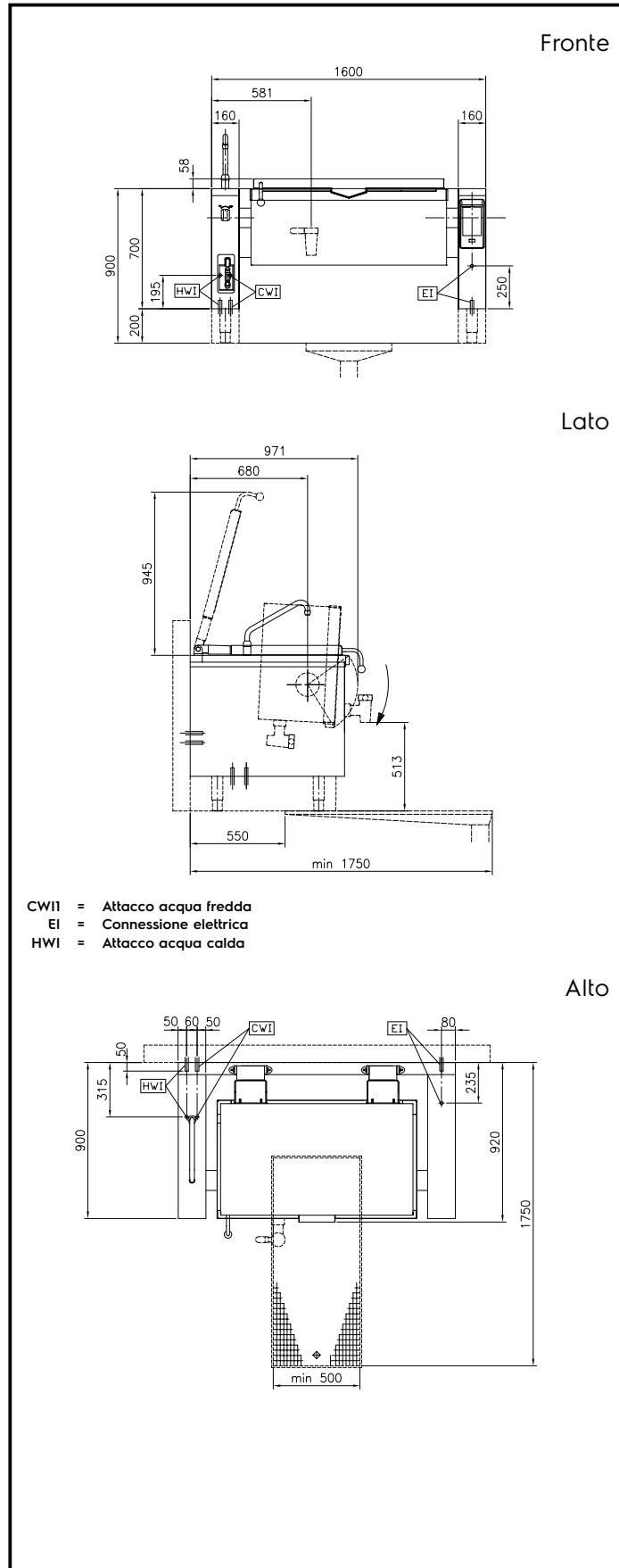
Brasiera elettrica basculante, con fondo in compound, 170 lt. (h), carico automatico acqua calda/fredda con rubinetto, doccetta, kit di chiusura posteriore.
